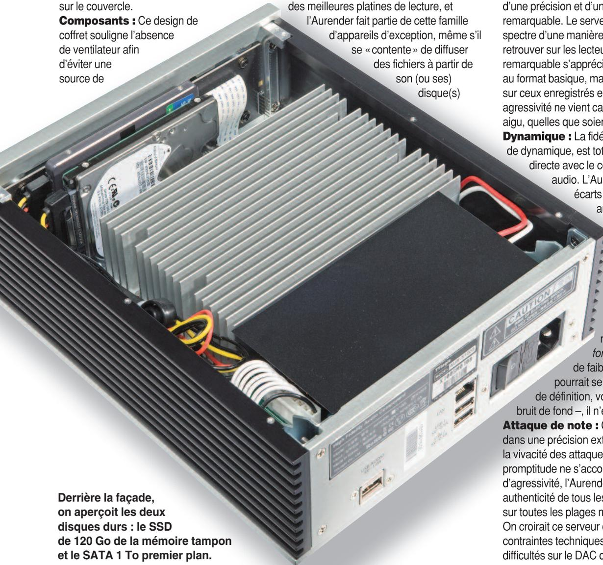
Derrière la façade, on aperçoit les deux disques durs : le SSD de 120 Go de la mémoire tampon et le SATA 1 To premier plan.
