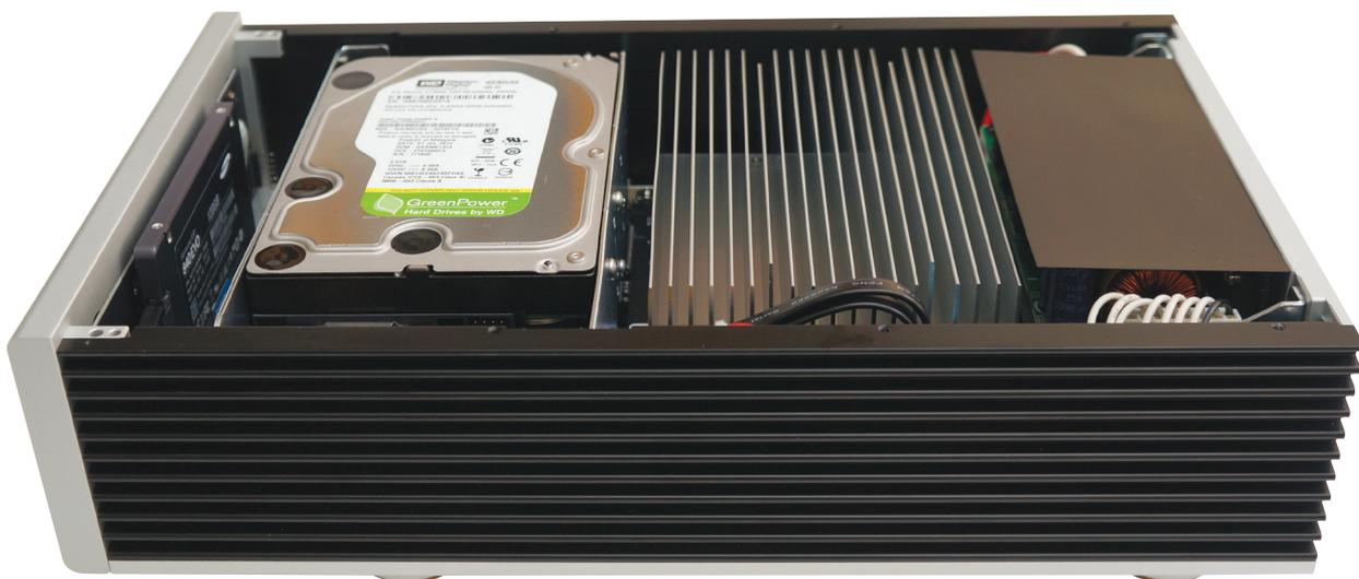
*Pour éviter les bruits parasites, l'alimentation (boîtier à droite) est encapsulée dans un compartiment en aluminium.*
