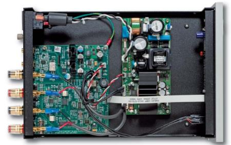
A gauche, la carte recevant les interfaces numériques, la correction RIAA, le DAC et les étages buffer de sortie. A droite, le module amplificateur lcepower.
